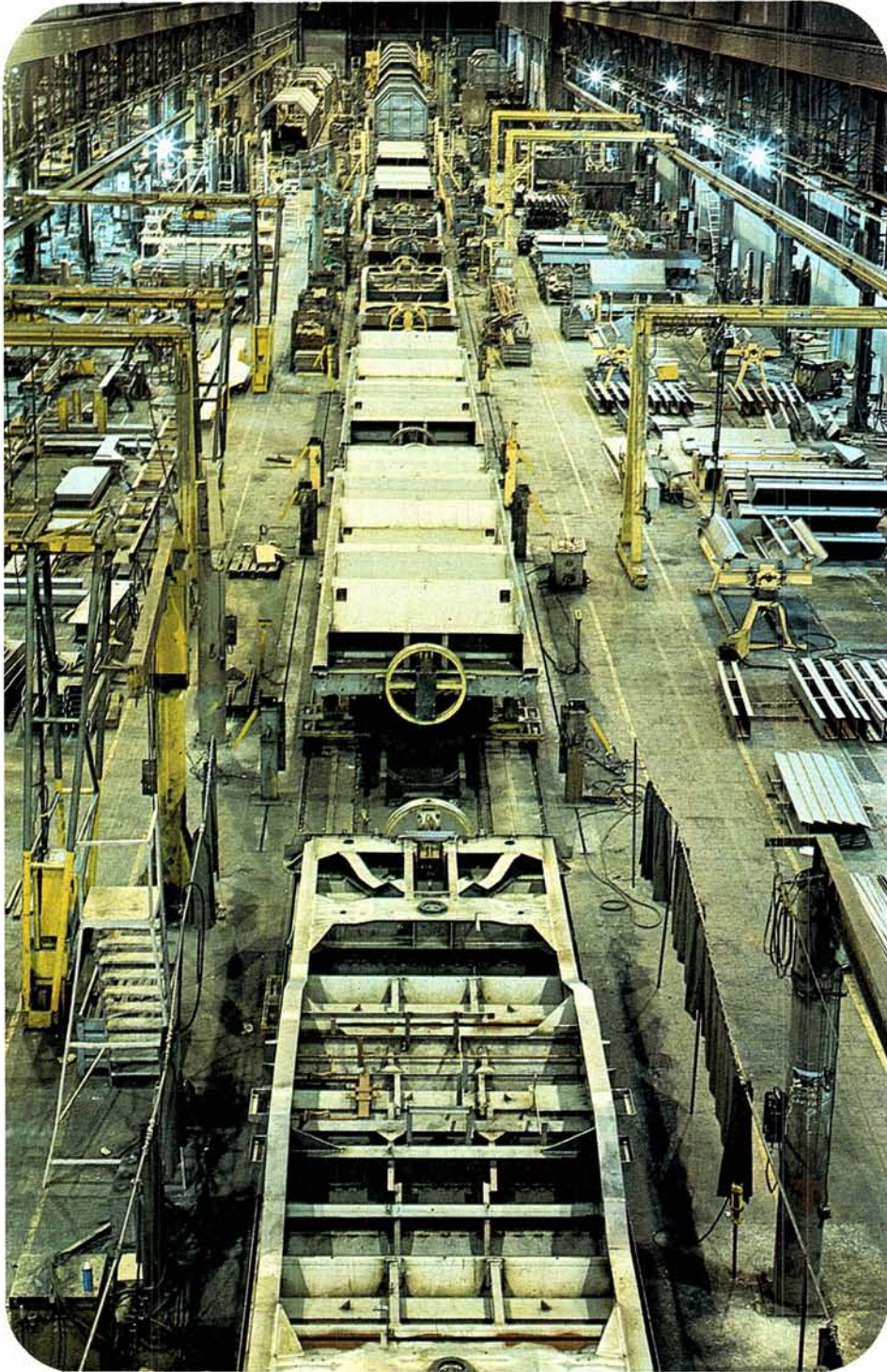
Production line of coil wagons Chaîne de montage des wagons pour le transport de bobines Montage lijn van de coilwagens
